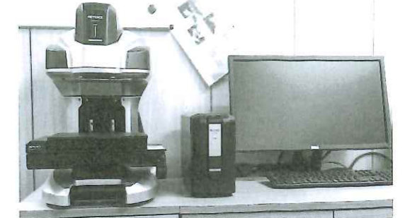
写真7 3Dで断面解析できる3D形状測定機(キーエンス)
