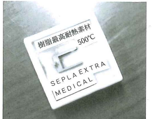
写真3 樹脂最高の耐熱温度500°Cを誇るセプラエクストラの微細加工
